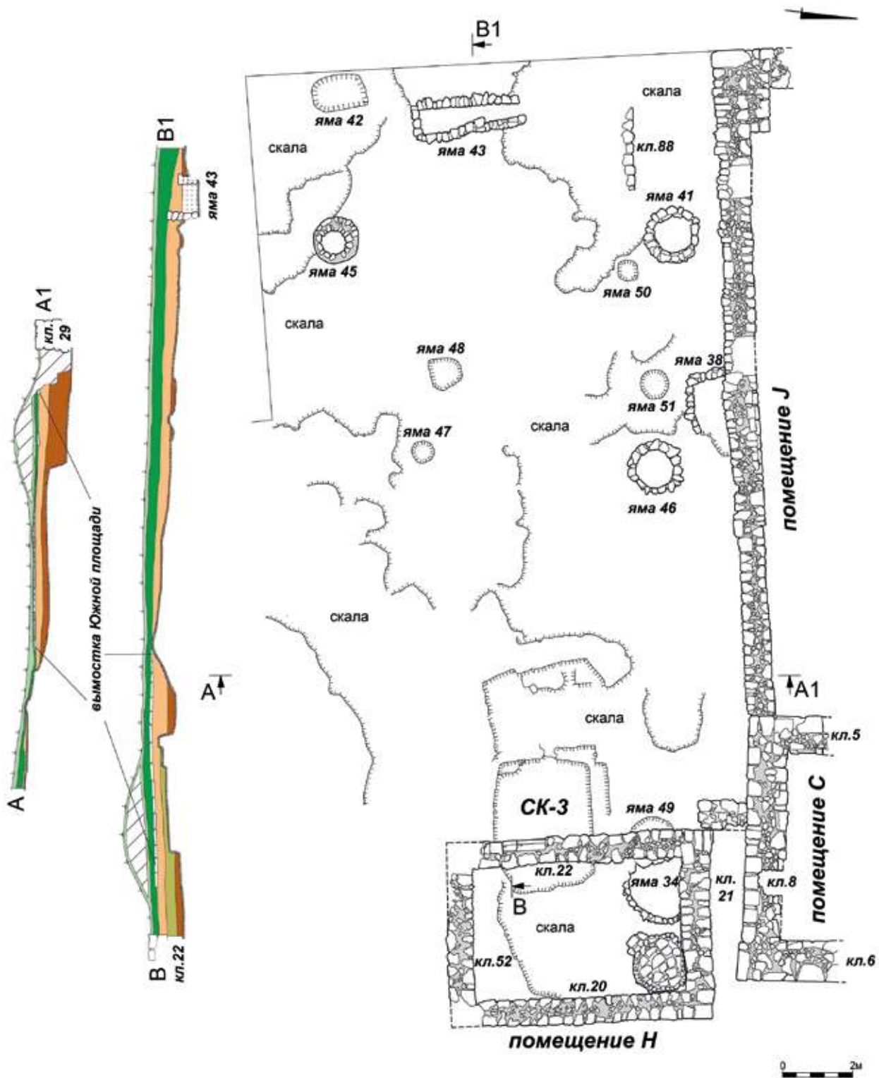
Рис. 105. Дворец. Юго-Западный участок. Раскопки 2010, 2014-2015 гг. Квадраты №№16-19, 22-25. Общий план строительных остатков по завершении работ. Генеральные стратиграфические разрезы
