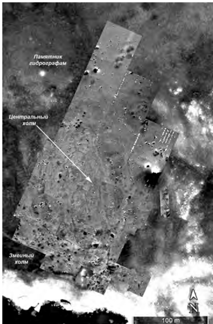
Рис. 1. Магнитная карта городища Киммерик, полученная в 2018 г., на фоне космического снимка. Светлые области соответствуют отрицательным, а темные — положительным аномалиям
